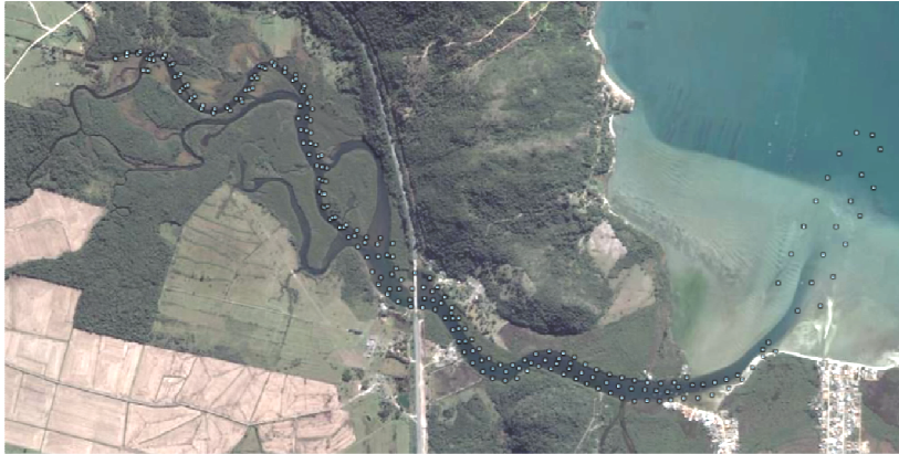
Figura 05 - Malha amostral batimétrica
