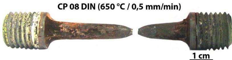
Figura 5.36 - Foto do CP DIN 08 fraturado no ensaio de tração a quente ( V_t = 0,5 mm/min e T = 650 °C).
