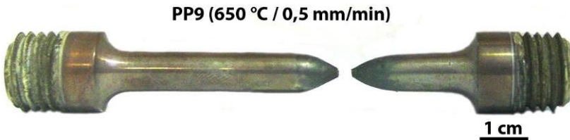
Figura 5.66 - Foto do CP PP9 (junta similar do aço P91) fraturado no ensaio de tração a quente (650 °C / 0,5 mm/min).
