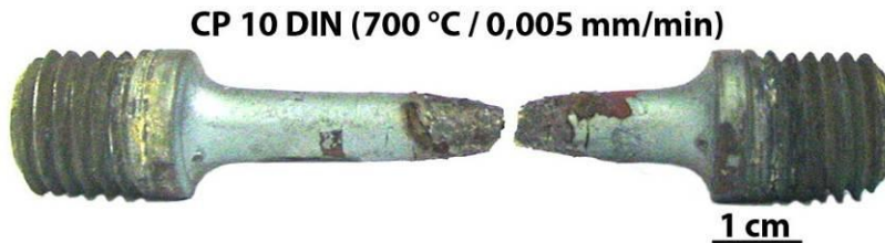
Figura 5.38 - Foto do CP DIN 10 fraturado no ensaio de tração a quente ( V_t = 0,005 mm/min e T = 700 °C).
