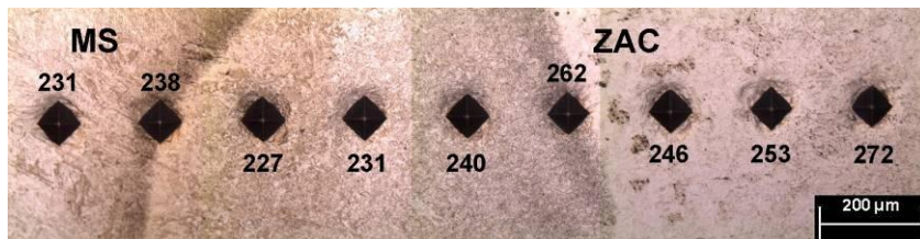
Figura 5.55 - Micrografia da solda dissimilar correspondente ao DP5 depois do TT, mostrando o MS, ZAC e MB DIN. Valores de dureza dados em HV. Ataque químico: Nital a 3%.
