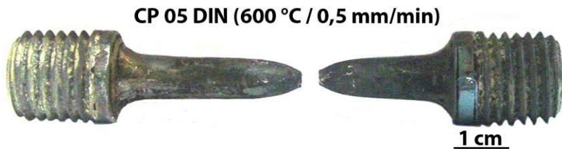
Figura 5.34 - Foto do CP DIN 05 fraturado no ensaio de tração a quente ( V_t = 0,5 mm/min e T = 600 °C).
