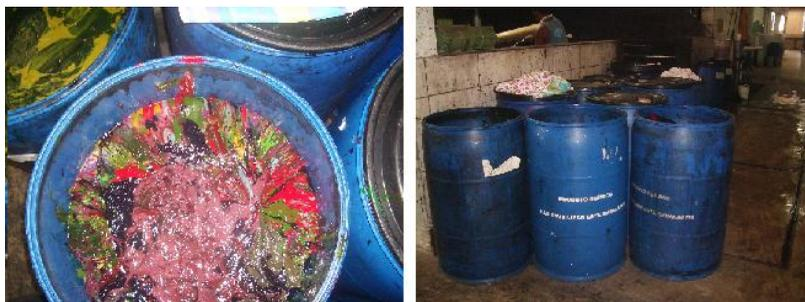
**Figura 18:** Recuperação e armazenamento de pastas de estampagem na Estamparia Cores e Tons.
