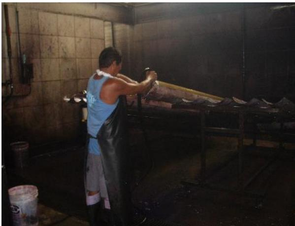
**Figura 19:** Lavagem dos cilindros de estampagem na Estamparia Cores e Tons.
