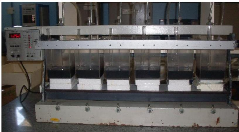
**Figura 5:** Teste de Jarros - *Marca Milan Modelo JT-103* utilizado nos experimentos no LIMA.
