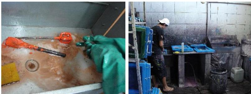
**Figura 11:** Lavagem dos materiais usados no processo de estampagem
