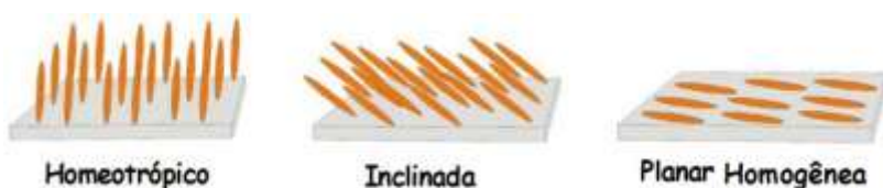
Figura 9: Os três tipos de orientações induzidas ao CL perto da superfície de contato: homeotrópico, inclinada e planar homogênea.
