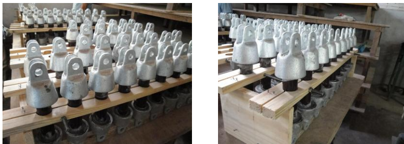
Figura 15. Fotografias mostrando corpos-de-prova para ensaio de tração dispostos em suporte de alinhamento em processo de cura do cimento.
