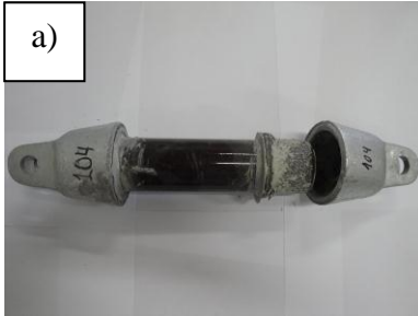
Figura 26(a) Fotografia de corpo-de-prova submetido a ensaio de tração contendo granilha 3 com substrato esmaltado.
