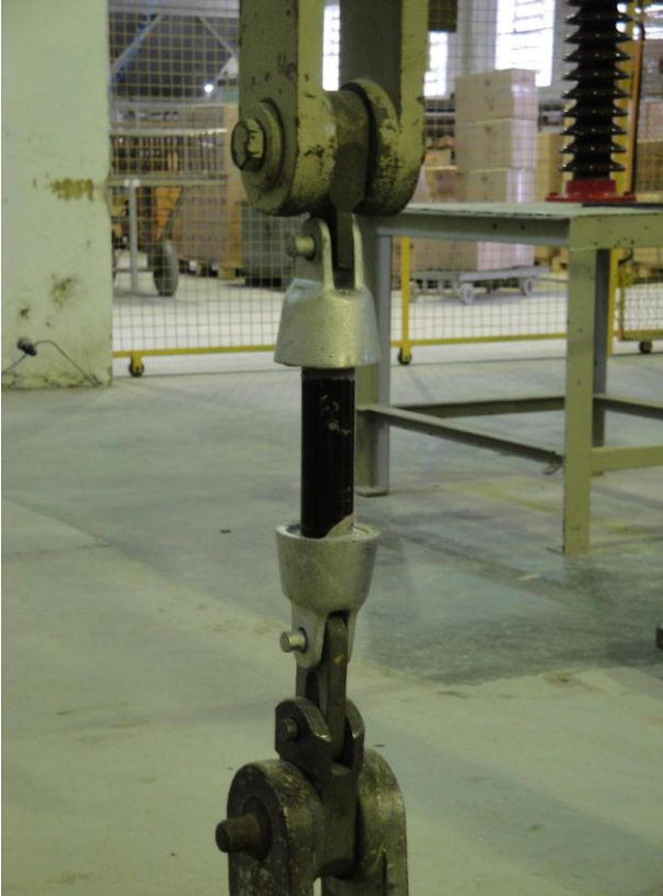
Figura 16. Fotografia mostrando o conjunto corpo-de-prova e ferragem cimentada submetido à ensaio de tração.
