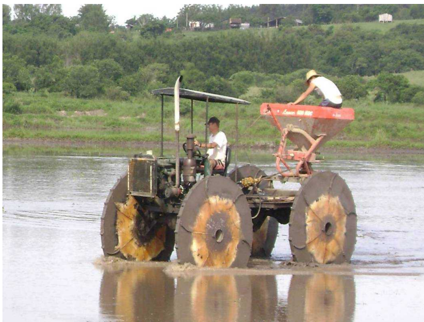
Figura 10 - Plantio do arroz pré-germinado a lança mecanizado. Fonte: Arquivo COPTec
