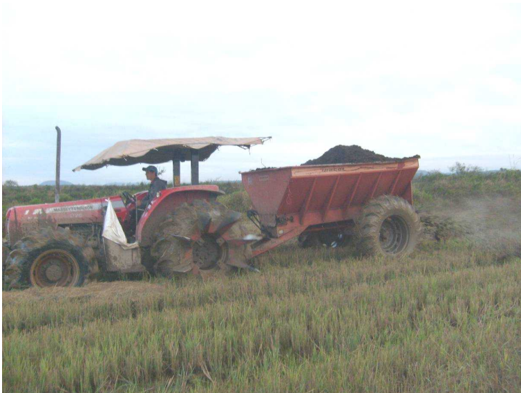
Figura 14 - Aplicação de cama sobreposta de suínos a lança mecânica. Fonte: Arquivo COPTec
