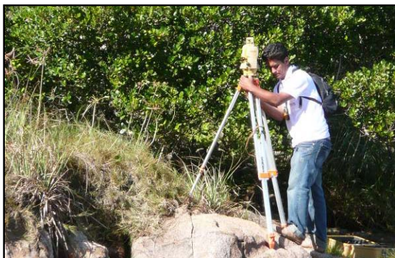
Foto 12 – Detalhe do momento de instalação da estação total, que constitui o equipamento de emissão e captação do sinal de transferência de dados, no ponto de amarração do levantamento (ponto L1). A estação total possui um sistema de nivelamento e alinhamento que permite a instalação na exata posição sobre um determinado ponto demarcado no solo.
