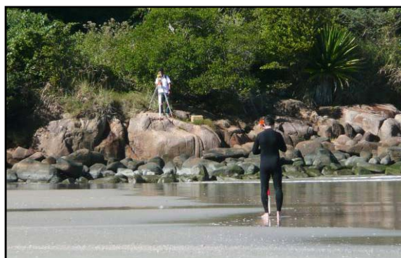
Foto 15 – Momento de aquisição de um ponto de controle para o levantamento topográfico planialtimétrico, na zona morfológica estirâncio.
