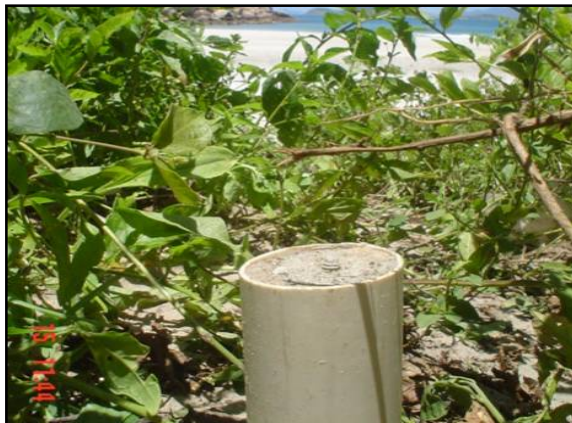
Foto 4 – Marco topográfico instalado na base do perfil praial 1. Foto de Alexandre Felix (15/12/2007).
