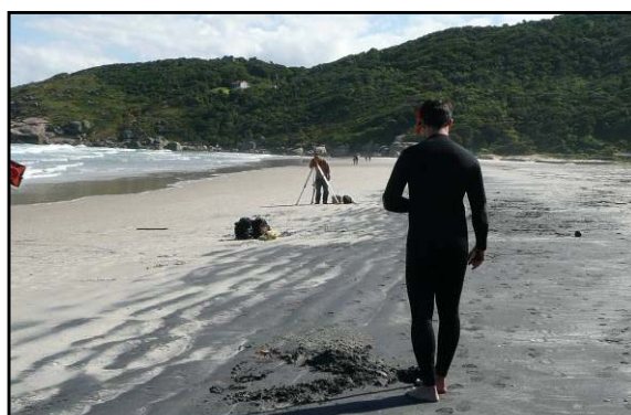
Foto 17 – Momento de aquisição de um ponto de controle para o levantamento topográfico planialtimétrico, na zona morfológica pós-praia. Neste momento, a estação total já tinha sido instalada em um novo ponto de amarração do levantamento, ponto conhecido como a vante. A técnica de irradiar um ponto a vante decorre da necessidade devido à aquisição de pontos localizados a grandes distâncias da estação total ou que não podem ser adquiridos diretamente a partir da mesma.
