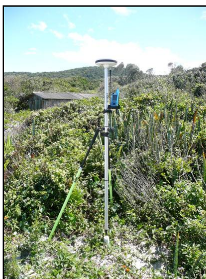
Foto 10 – Receptor GPS da marca Ashtech de propriedade do Laboratório de Geoprocessamento da UFSC, instalado sobre o ponto de amarração L2 do levantamento topográfico.
