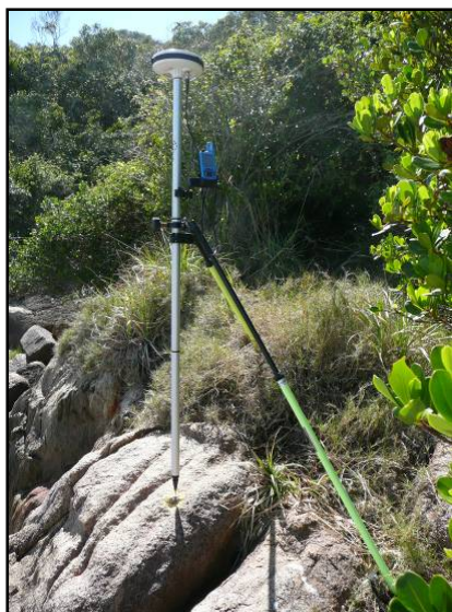
Foto 8 – Receptor GPS da marca Ashtech de propriedade do Laboratório de Geoprocessamento da UFSC, instalado sobre o ponto de amarração L1 do levantamento topográfico.
