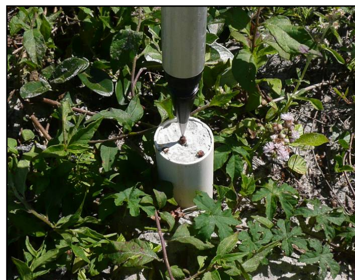
Foto 11 – Detalhe do ponto de amarração L2, onde se observa a acurácia proporcionada pela base do tripé de altura fixa do aparelho, instalado exatamente sobre o pino saliente no centro da extremidade do marco topográfico.
