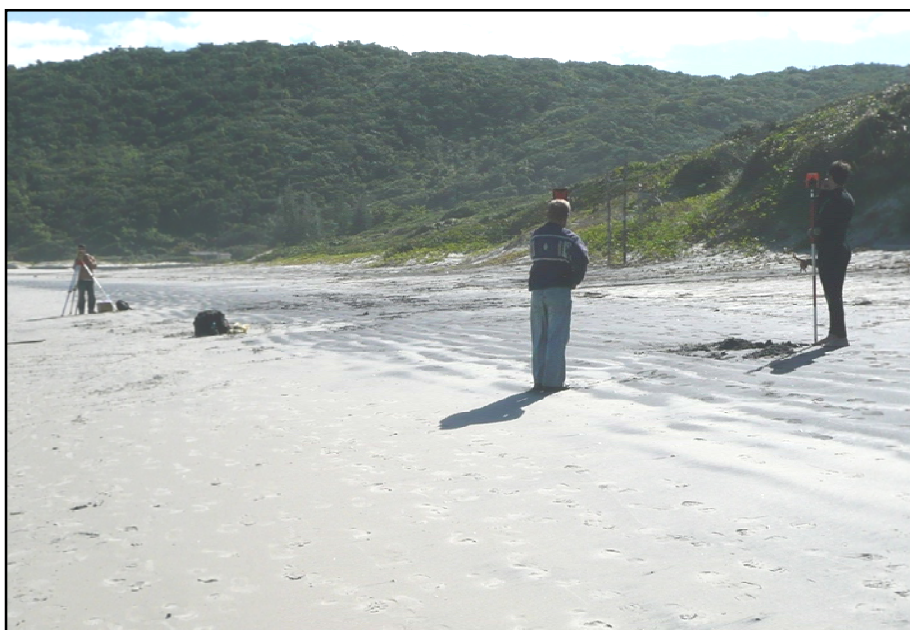
Foto 18 – Vista geral do acúmulo de minerais pesados na praia dos Naufragados, formados pela ação de ondas de tempestade após os três primeiros eventos de alta energia hidrodinâmica registrados. Este acúmulo apresentou-se em forma de uma faixa contínua, com largura variando em torno de 10 m em toda a extensão da praia, a partir da base da duna frontal em direção a linha de costa.
