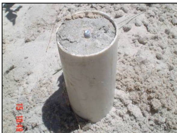
Foto 7 – Detalhe do marco topográfico instalado na base do perfil praial 3. Observam-se a altura da porção exposta do marco (aproximadamente 10 cm acima do nível do solo) e o pino saliente na parte central de sua extremidade, que servirá de base para estação do perfil praial. Foto de Ulisses Rocha de Oliveira (15/12/2007).
