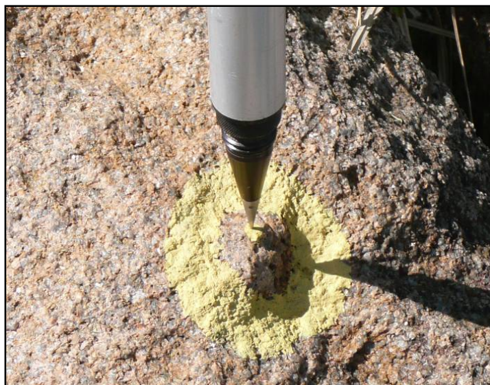
Foto 9 – Detalhe do ponto de amarração L1, onde se observa a acurácia proporcionada pela base do tripé de altura fixa do aparelho, instalado exatamente na marca fixa sobre as rochas do costão da porção mais a leste da praia dos Naufragados.
