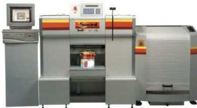
**Figura 37** - Sistema tintométrico de fabricante de tintas.
