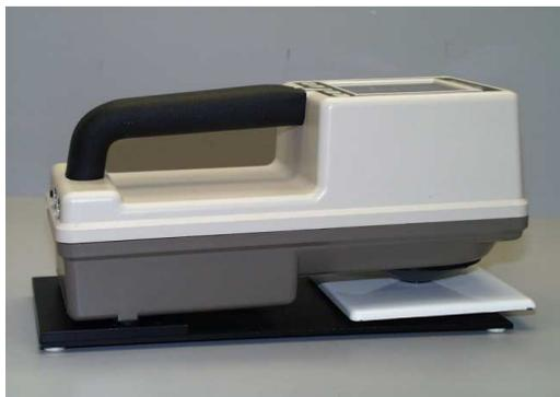
**Figura 73** - Calibração sendo realizada com a placa cerâmica branca. Fonte: HunterLab, 2010
