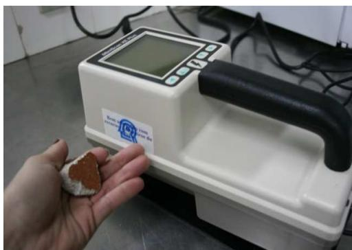
**Figura 74** - Amostra a ser analisada em espectrofotômetro. Fonte: HunterLab, 2010
