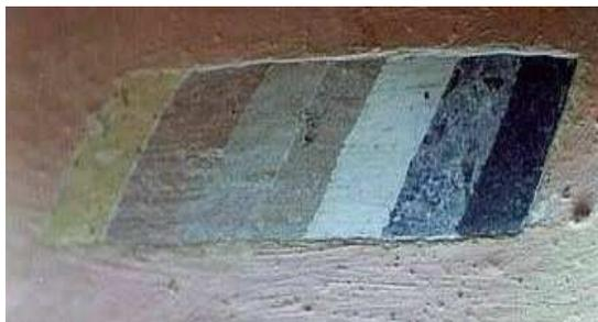
**Figura 16** – Ensaio estratigráfico.
