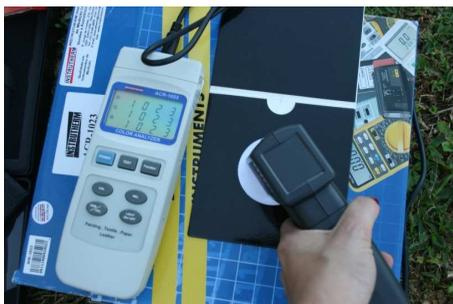
**Figura 68** - Processo de calibração do Analisador de cor ACR-1023.
