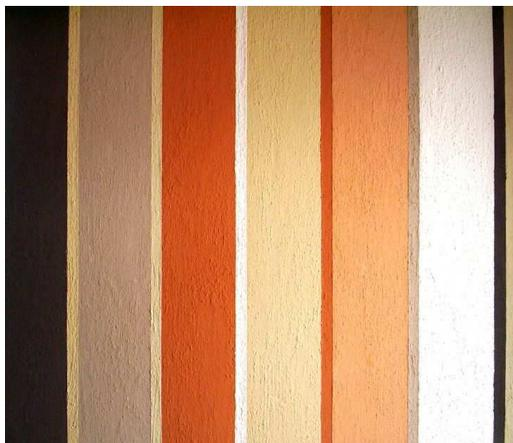
**Figura 8** - Cores da caição obtidas com pigmentos de terra.
