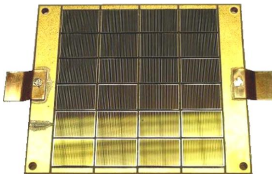
Figura 2.18 - Montagem de arranjo com 24 células ( 100\text{ cm}^2 ). Fonte: (LUTHER et al. , 2007)
