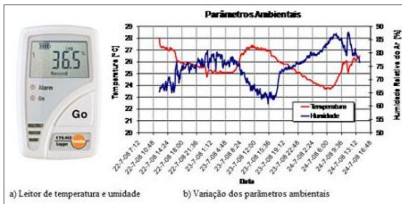
Figura 45– Leitor e resultados da variação da temperatura e umidade
