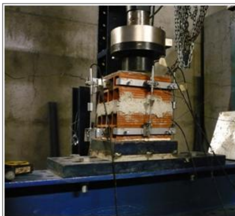
Figura 106 – Utilização de braçadeiras para fixação dos LVDTs
