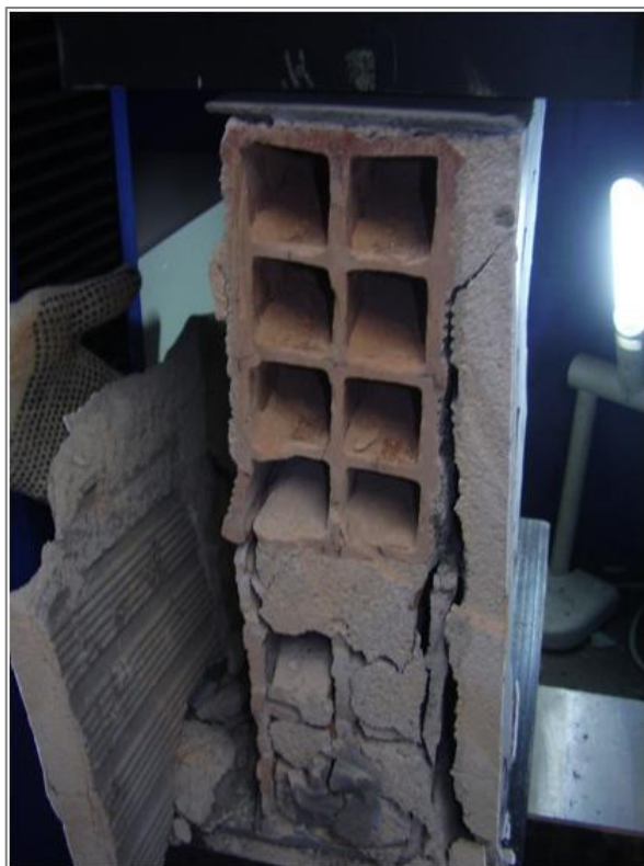
Figura 129 – Destacamento dos revestimentos do prisma SENAI-PE
