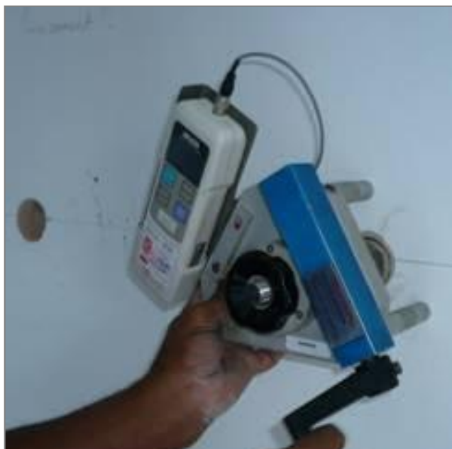
Figura 85 – Realização do ensaio de resistência de aderência à tração
