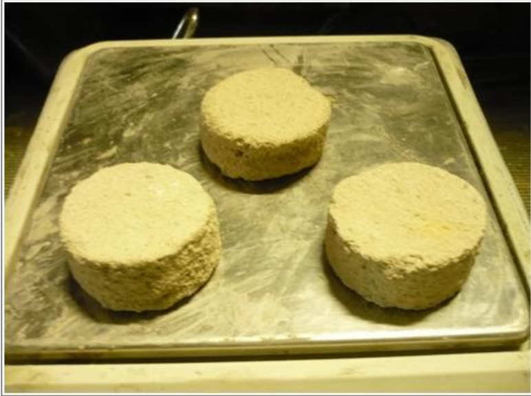
Figura 102 – Característica geométrica da argamassa retirada do edifício
