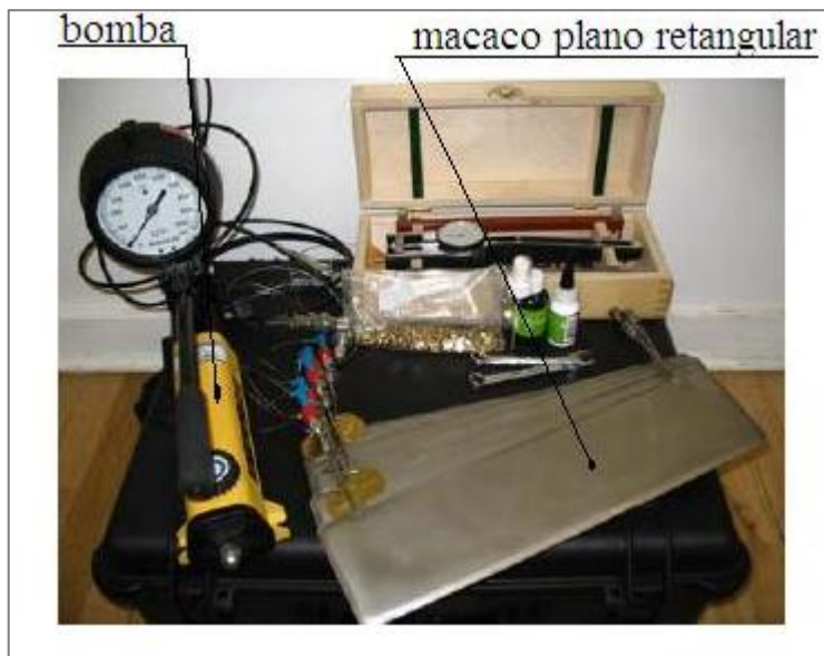
Figura 16 – Equipamentos que fazem parte do ensaio com macacos Fonte: Google Imagem
