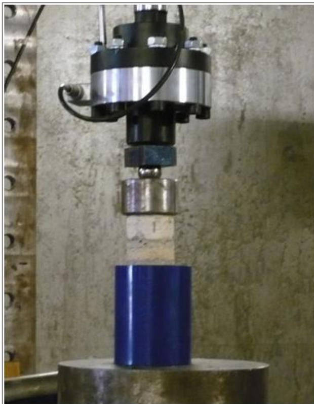
Figura 103 – Ensaio de resistência à compressão de argamassa
