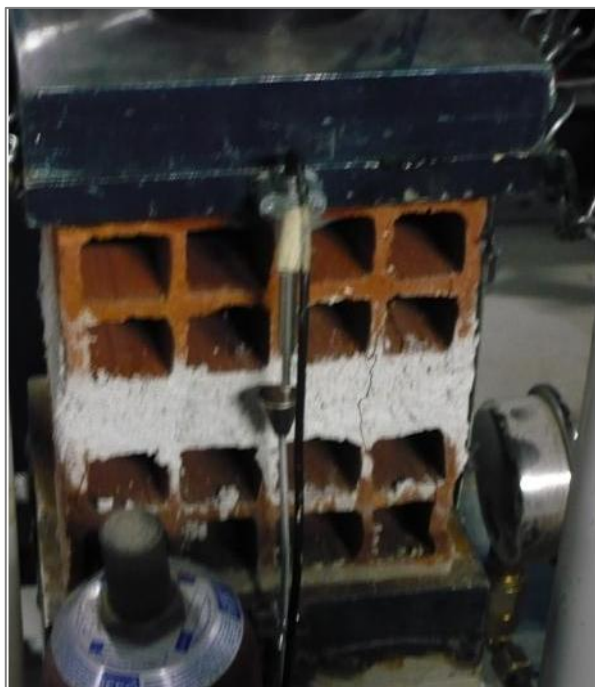
Figura 118 – Fissuramento nos prismas não saturados
