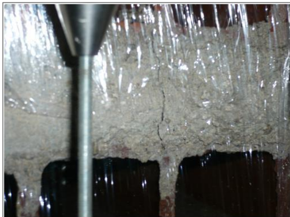
Figura 117 – Fissuramento nos prismas saturados
