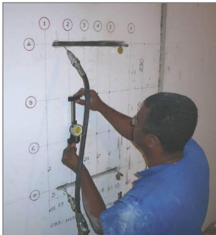
Figura 69 – Ensaio C: leitura da deformação
