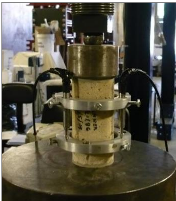
Figura 98 – Posição dos LVDTs para obtenção do módulo de elasticidade
