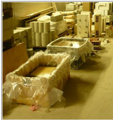
Figura 119 – Prismas do EC nas caixas de água no ambiente do laboratório da UMinho
