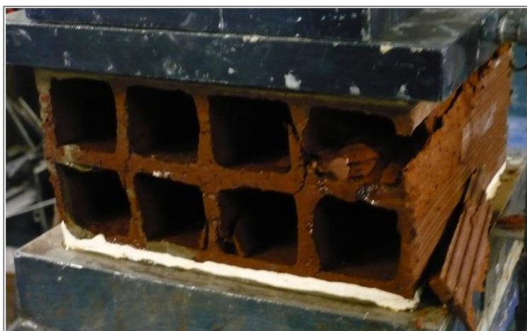
Figura 93 – Ruptura do bloco
