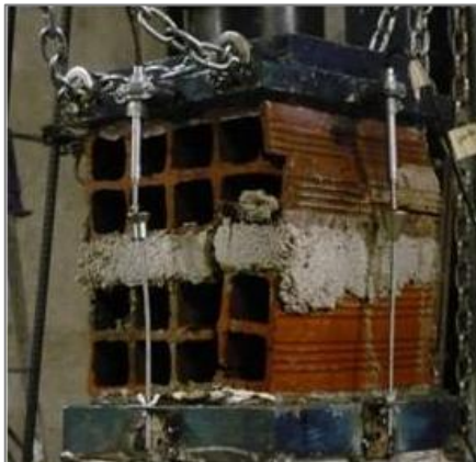
Figura 110 – Forma de ruptura dos prismas
