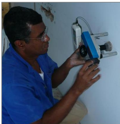
Figura 101 – Ensaio de resistência de aderência à tração
