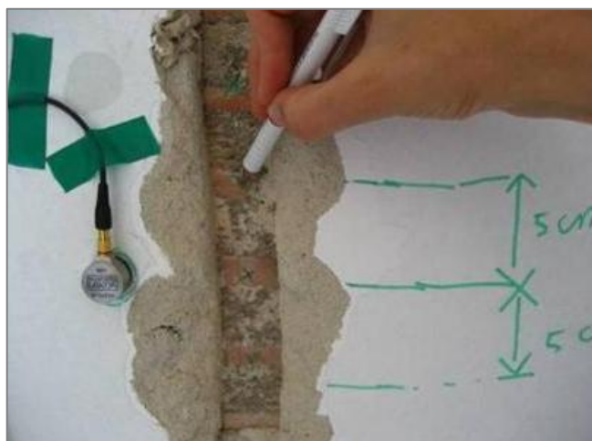
Figura 76 – Análise de sinais entre o bloco e revestimento
