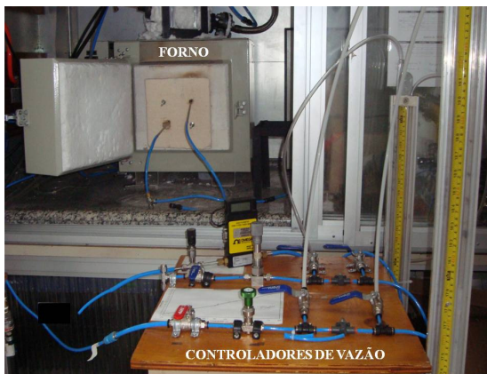
Figura 8: Fotografia da bancada laboratorial com os controladores de vazão e do forno utilizado.
