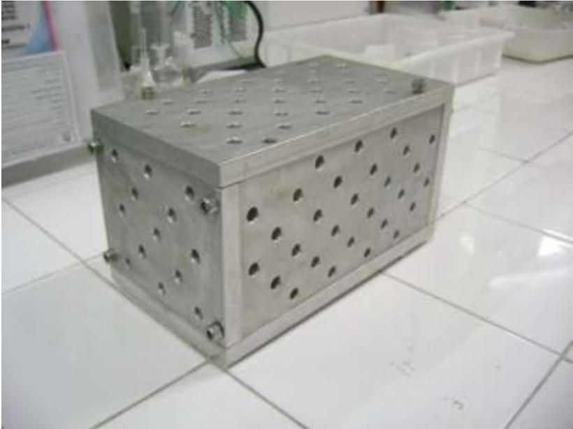
Figura 3.5 – Molde metálico para EPS
