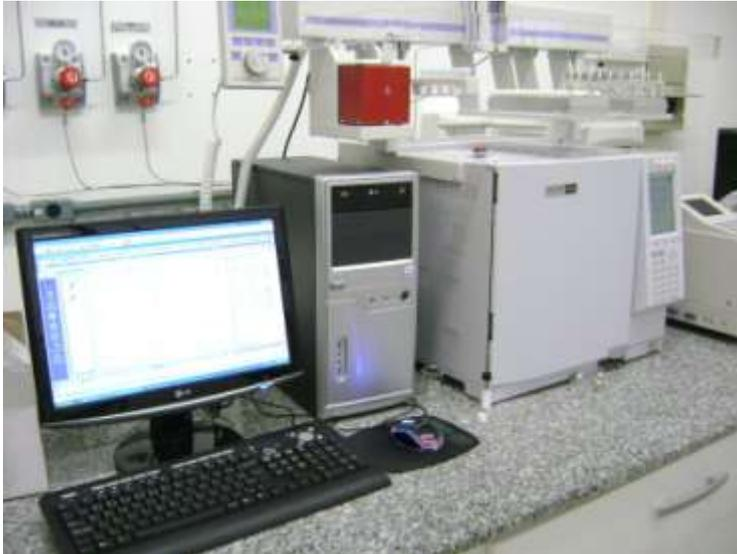
Figura 3.7 - GC-2010AF acoplado a um headspace (modelo AOC-5000 Shimadzu)
