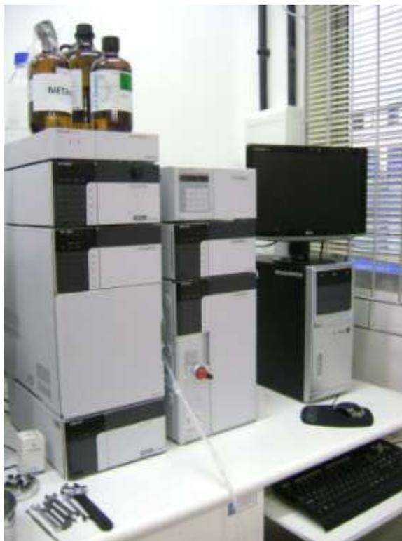
Figura 3.6 - HPLC, modelo LC-20A, Shimadzu
