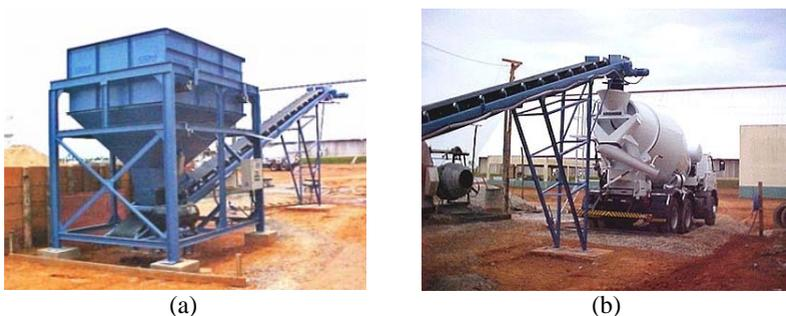
Figura 8 – Central “Tow go”: (a) balança; (b) correia transportadora e caminhão betoneira [CSM, 2009].
