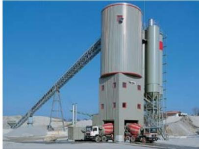
Figura 6 – Central Vertical ou de gravidade [STETTER, 2009]
