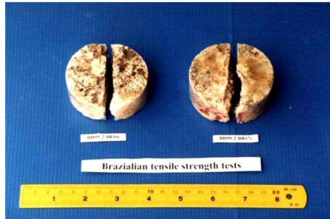
Figura 2.13: Corpos de prova do teste de tração indireta brasileiro após a falha [23].
