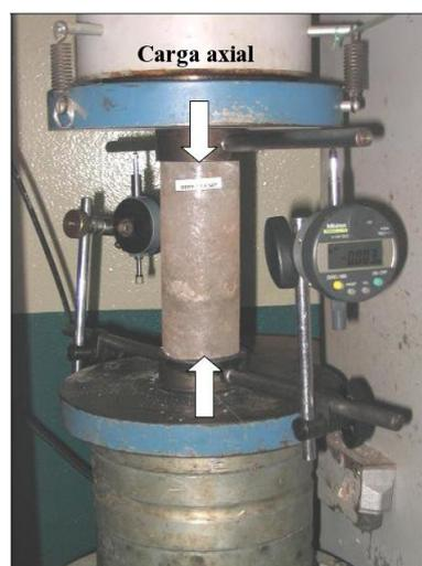
Figura 2.14: Ensaio de resistência à compressão uniaxial com taxa de carregamento constante. A amostra cilíndrica é carregada verticalmente utilizando a máquina de compressão [23].
