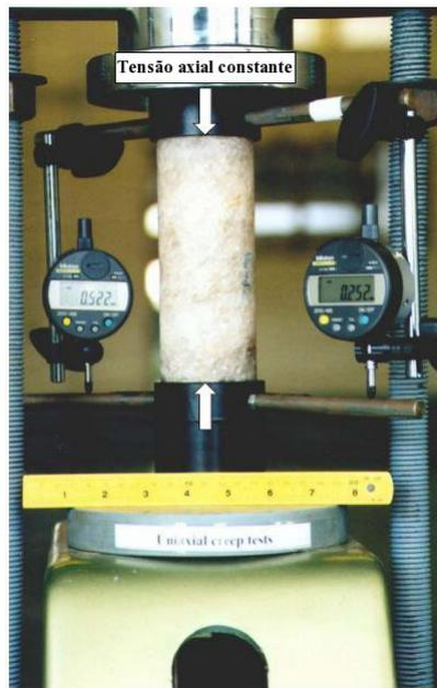
Figura 2.21: Aparato experimental do ensaio de fluência uniaxial [24].
