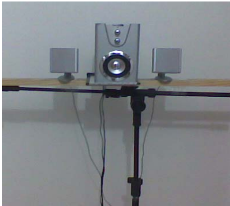
Figura 3.5: Montagem do esquema acústico de emissão de ruído para o efeito Lombard
