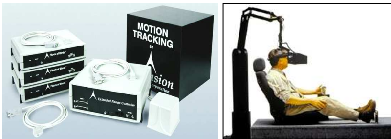
Figura 5: Dispositivo para rastreamento magnético (esquerda) 2 e mecânico (direita) 3 .
