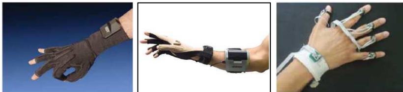
Figura 4: Modelos de luvas instrumentadas (DIPIETRO et al., 2008).
