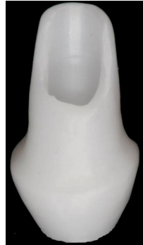
Figura 28 – Contração de 25% após sinterização.
