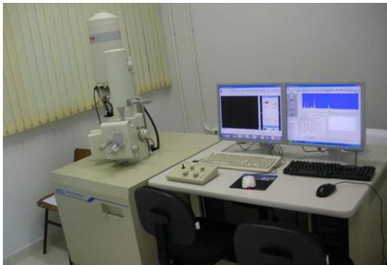
Figura 32 - Microscópio eletrônico de varredura utilizado para mensurar a área da interface entre implante e intermediário.
