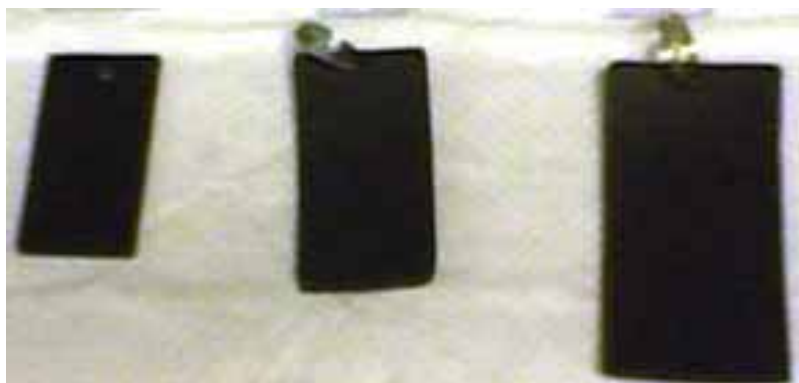
Figura 32. Variação do tamanho de corpos de prova submetidos a diferentes solventes: à esquerda uma borracha após o processo de extração em acetona, no centro uma peça após 5 dias de imersão em heptano e à direita uma peça após 5 dias de imersão em tolueno.
