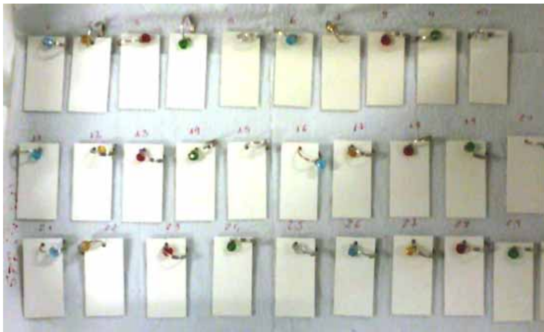
Figura 20. Confecção de corpos de prova de borrachas de silicone com a afixação de contas de vidro coloridas para a diferenciação das peças.
