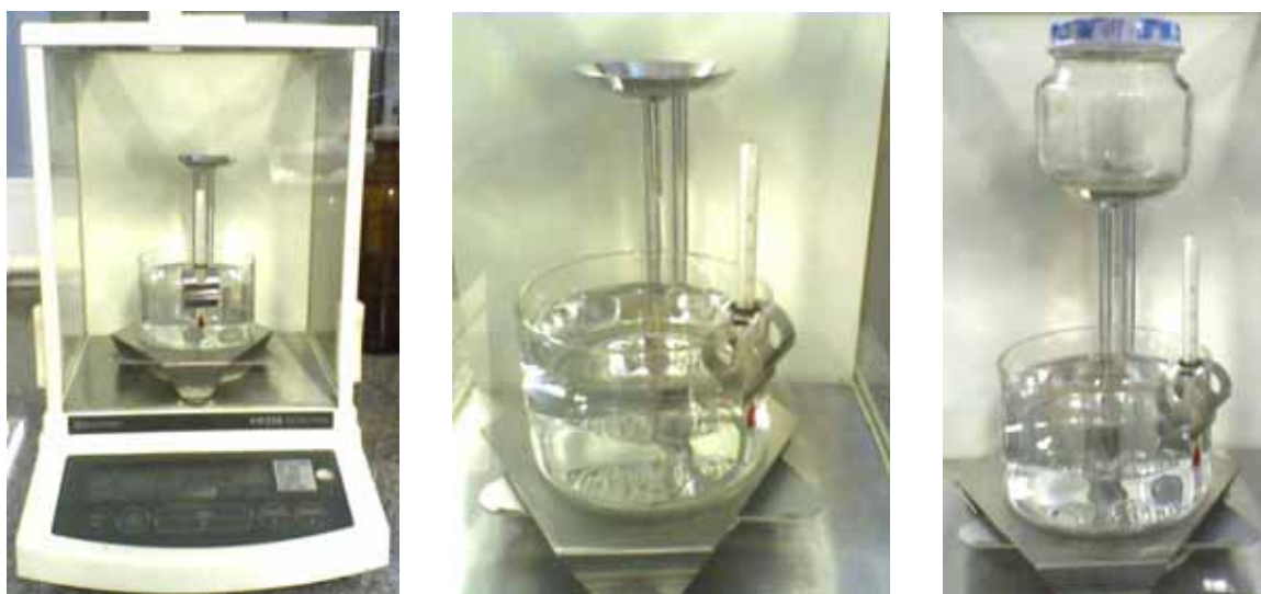
Figura 22. Aparato para determinar massa específica de sólidos.
