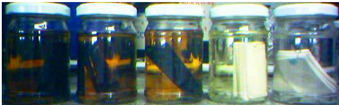
Figura 25. Extração com acetona das borrachas SBR, natural, neoprene, SBR alimentício e silicone, nesta ordem da esquerda para a direita, ao final do primeiro dia evidenciando a variação de tonalidade da acetona devido à quantidade de material extraído das borrachas.
