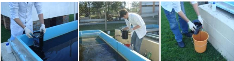
Figura 6 - Retirada dos coletores de lodo das Lagoas de Tratamento
