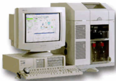
Figura 40. Aparelho de eletroforese capilar utilizado nas determinações de perácidos.
