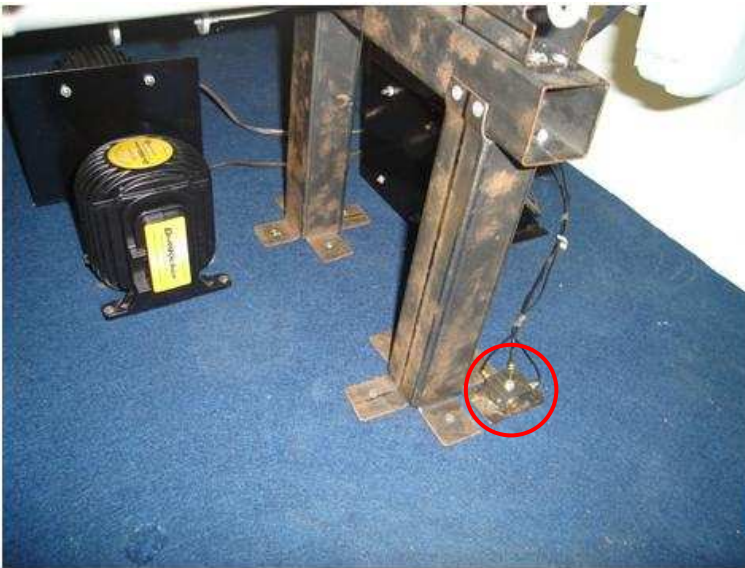
Figura 48: Posicionamento do acelerômetro em relação ao pé da poltrona e dos excitadores.
