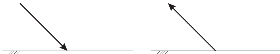
Figura 27: Condição de contorno de Bounce-Back.
