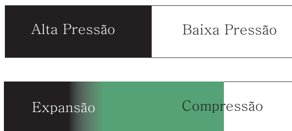
Figura 36: Tubo de choque de Sod.
