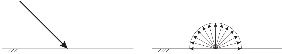
Figura 28: Condição de contorno de equilíbrio ou difusa.
