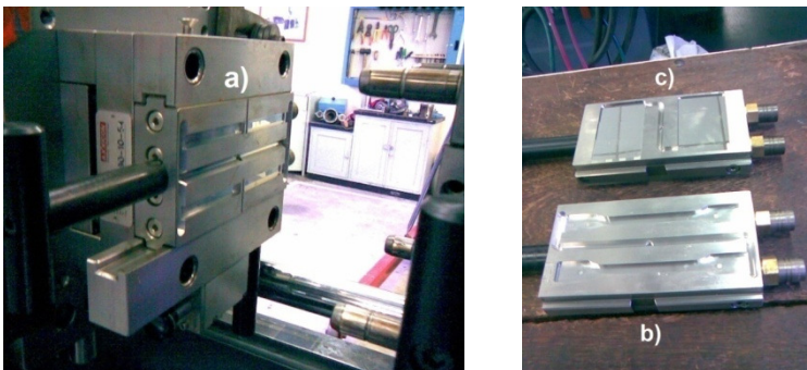
Figura 11: Molde ISO com cavidade de corpo de prova de impacto (a), moldes ISO de tração (b) e cor (c).
