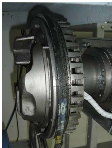
Fig. 1.2 – Gerador de ímãs permanentes com fluxo axial usado neste trabalho.
