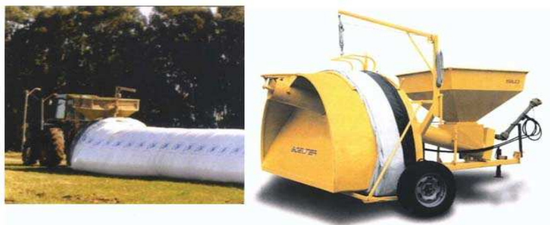
Figura 11 - Exemplo de armazenamento de silo hermético – tipo silos bag
