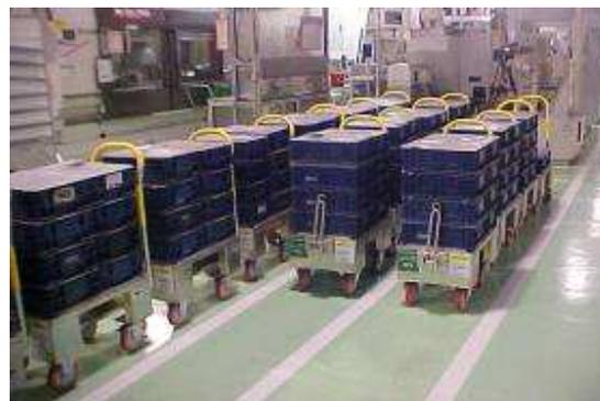
Figura 4.6 – Supermercado dos Corpos de Injetor A e B. Fonte: Dados da Empresa (2008).
