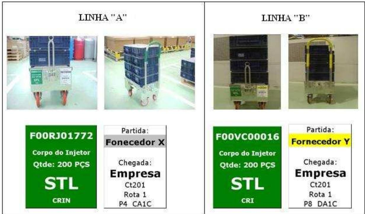
Figura 4.5 – Identificação dos *Rollers-kanban*. Fonte: Dados da Empresa (2008).
