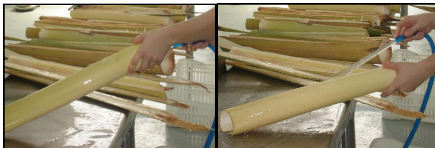
Figura 2 Higienização com água corrente das bainhas foliares de palmeira real australiana (Acervo do autor).
