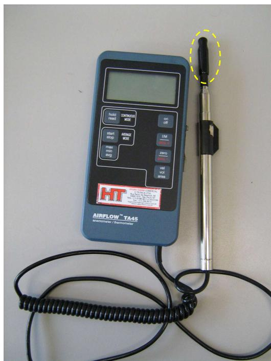
**Figura 19.** Termo-anemômetro *Airflow TA45*.
