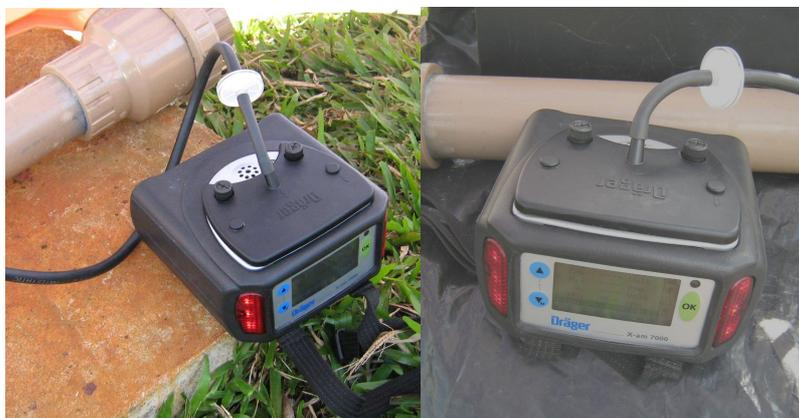
**Figura 18.** Medidor de gases *Dräger X-am 7000*.
