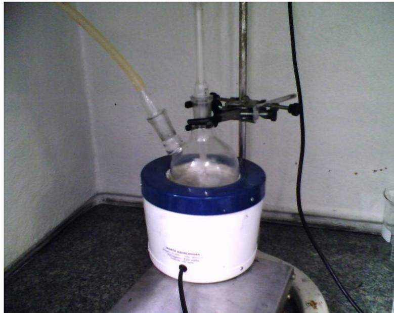
*Figura 18 – Preparação da resina epóxi: aquecimento e vácuo para eliminação de bolhas.*
