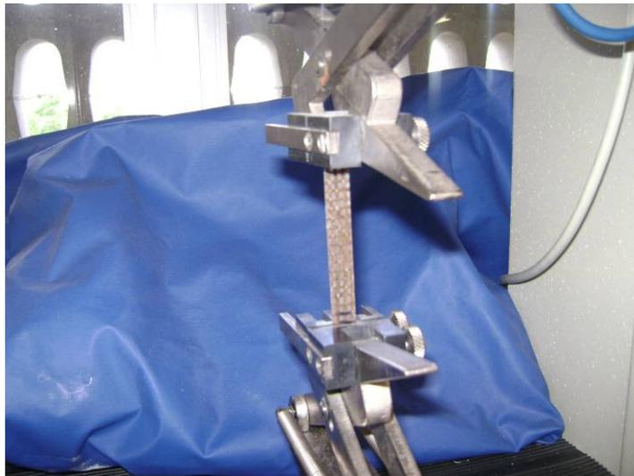
Figura 23 – Execução de ensaio de tração em compósitos.
