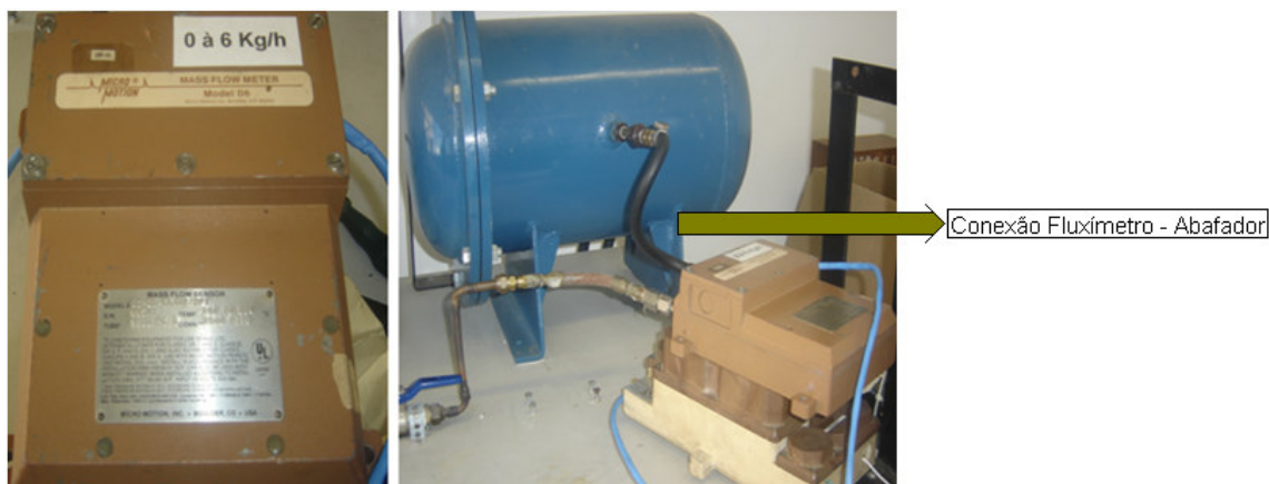
Figura 5.5: a) Fluxímetro MicroMotion modelo D6, b) Detalhe do fluxímetro conectado ao sistema
