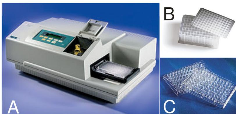
Figura 15: A – Espectrofotômetro Spectra Max Plus 384 da Molecular Devices. B – Microplaca de 2mL. C – Microplaca de 300µL.
