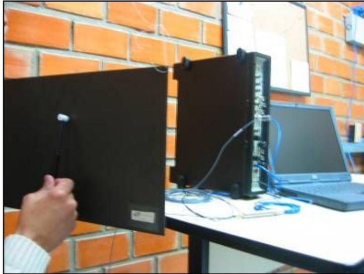
Figura 3.4 – Montagem do experimento de determinação de função resposta em frequência com o martelo de impactação.
