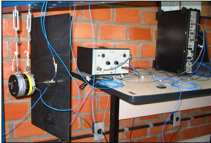
Figura 3.2 – Montagem do experimento de determinação de função resposta em frequência com o excitador eletrodinâmico.
