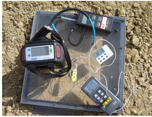
Figura 20. Leituras na placa de fluxo.
