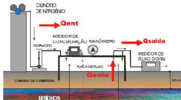
Figura 7. Esquema de placa de fluxo dinâmica.
