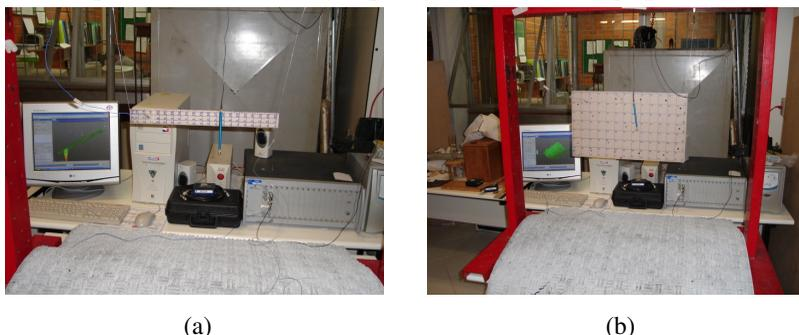
O objetivo principal desse experimento foi o de determinar os modos fundamentais de flexão das amostras nas direções “X” e “Y” respectivamente, como também o modo fundamental de torção, viabilizando a verificação de aplicabilidade da norma *ASTM E 1876 – 01* na obtenção das propriedades de materiais sanduíches com núcleo tipo colmeia, não necessitando, portanto, da realização de ensaios destrutivos.
