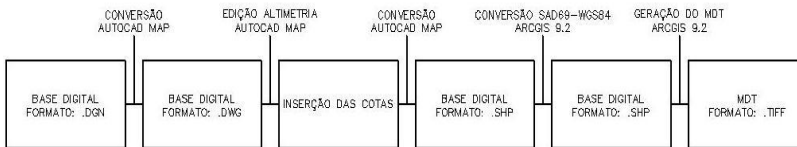
Figura 22: Fluxograma da edição da base altimétrica e geração do MDT.
