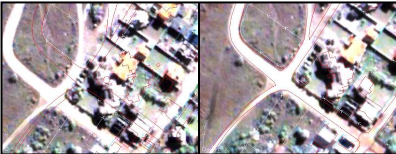
Figura 32: a) Base sobreposta a imagem bruta. b) Base sobreposta à imagem após o processamento de ortoretificação.
