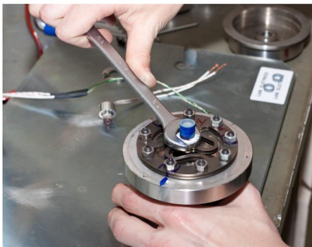
Figura 38 – Montagem do suporte do ímã na mola ressonante.
