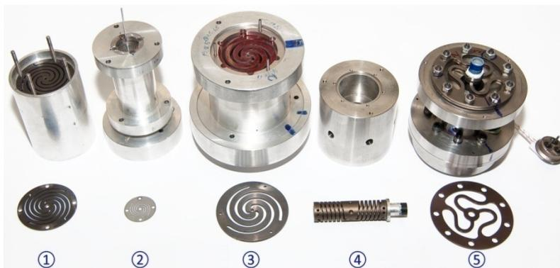
Figura 36 – Dinamômetros avaliados ao longo dos testes.
