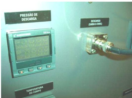
**Figura 3.8 -Controlador Euroterm e engate BNC usados para a leitura de pressão.**
