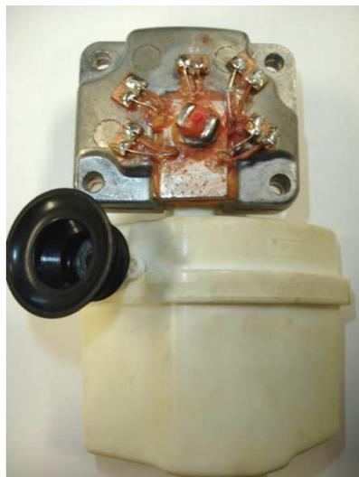
**Figura 5.10 - Conjunto filtro-tampa para a sonda de micro-termopar pronto.**
