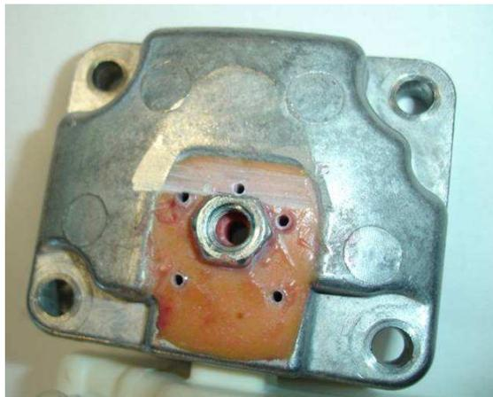
**Figura 5.8 - Conjunto filtro-tampa com os furos passantes para a instalação dos termopares.**
