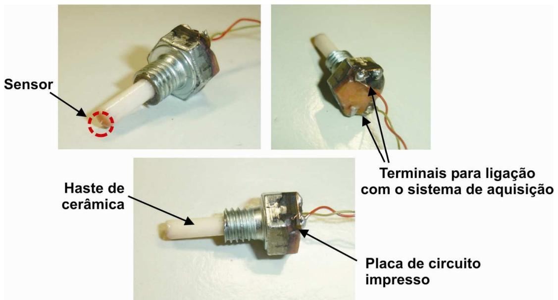
Figura 5.2 - Sonda de micro-termopar construída.
