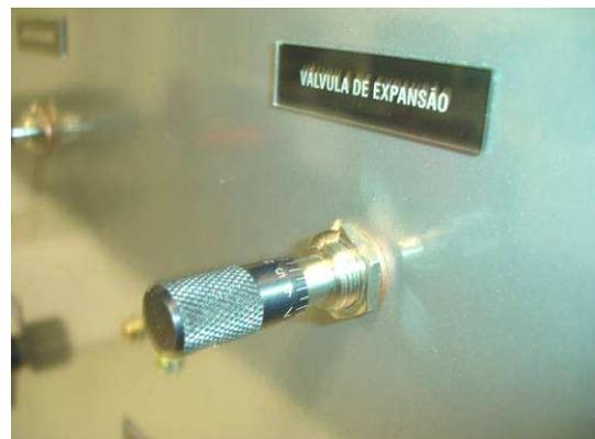
**Figura 3.9 -Válvula de expansão usada no controle da pressão de sucção.**
