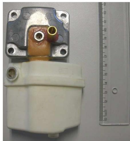
**Figura 5.12 - Conjunto filtro-tampa pronto para medição com os alojamentos para a sonda de anemometria e para o transdutor de pressão.**
