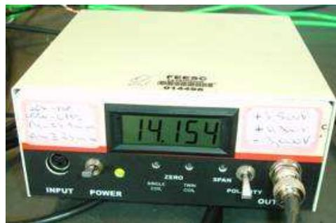
**Figura 3.16 - Gerador de sinais utilizado para medir o movimento da válvula de sucção.**
