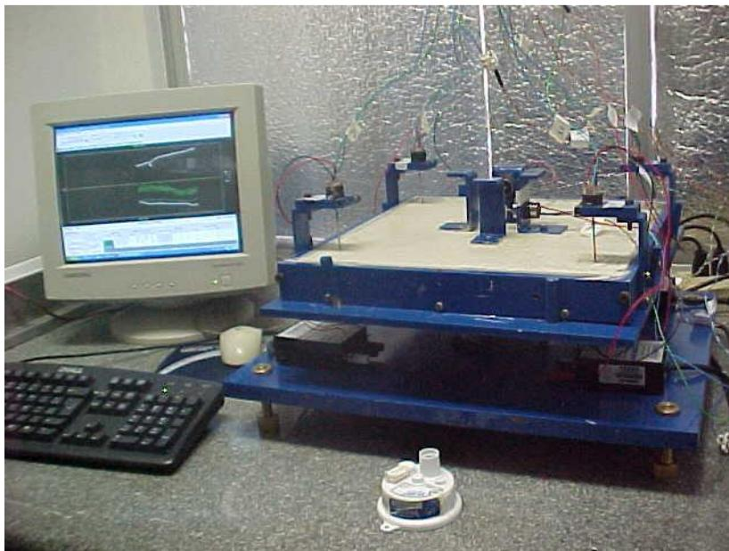
Figura 18 – Equipamento para ensaio de retração por secagem
