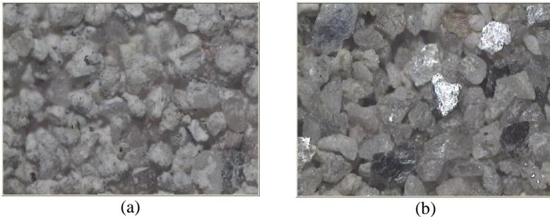
Figura 21 – Imagens microscópio óptico (50x): (a) AGR; (b) Areia natural
