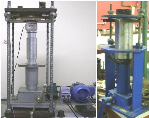
Figura 3.6 Processos de (a) compactação por duplo pistão e, de (b) desmoldagem dos corpos de prova. (BARRA, 2009)
