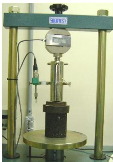
Figura 3.8 Corpo de prova durante o processo de ruptura à compressão simples. (BARRA, 2009)
