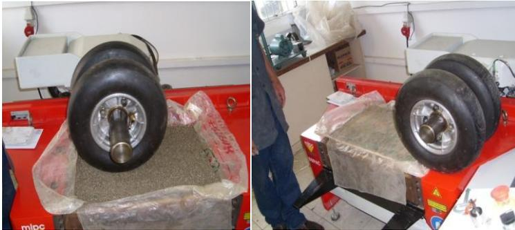
Figura 5.12 Processo de compactação da brita graduada simples
