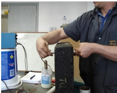
Figura 5.4 Procedimento para o ensaio do método direto com ultra-som com o transdutor de 200 kHz
