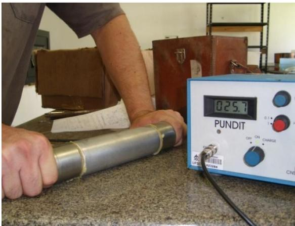
Figura 4.1 Processo de calibração do aparelho com o PUNDIT 6.
