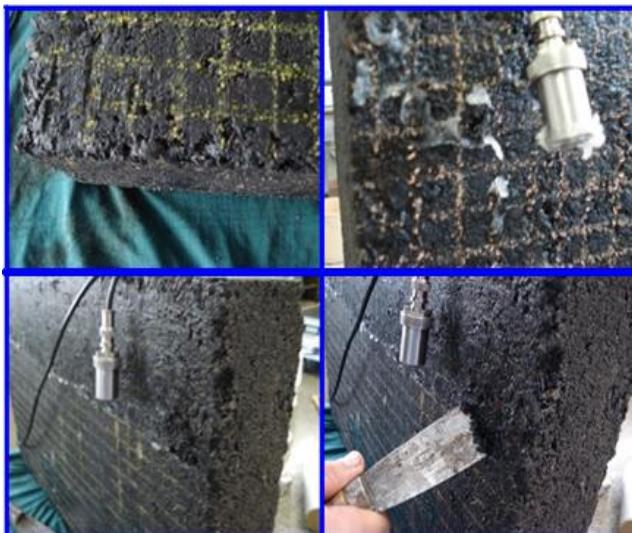
Figura 4.2 Efeitos da vaselina no Corpo de Prova testado.
