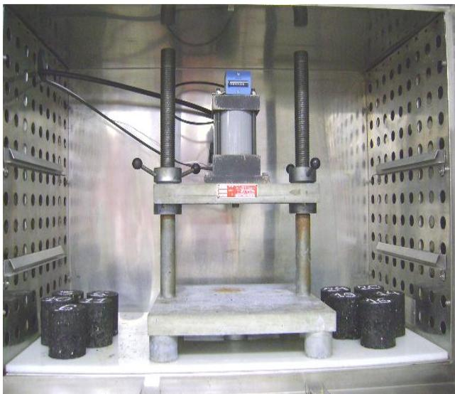
Figura 3.7 Corpos de prova condicionados em câmara térmica (18°C e umidade relativa do ar a  $50\% \pm 10\%$ ). (BARRA, 2009).
