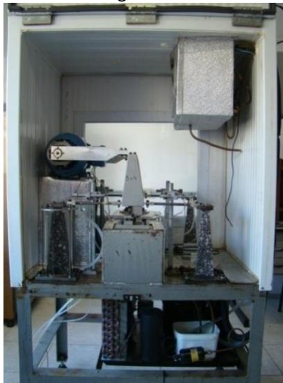
Figura 3.18 Protótipo inicial da primeira máquina de fadiga e do módulo complexo do Brasil, desenvolvida no laboratório de pavimentação da UFSC.
