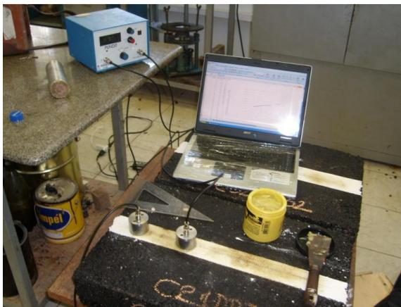
Figura 5.8 Processo de ensaio pelo método indireto
