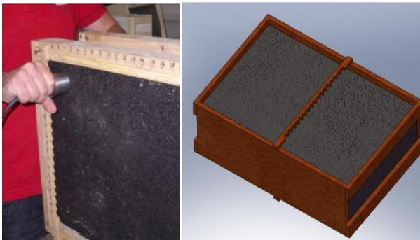
Figura 5.6 Gabarito utilizado para a localização dos transdutores nos ensaios de ultra-som pelo modo de transmissão direto.
