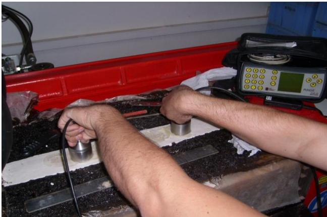
Figura 5.13 Camada de gesso fina aplicada sobre o revestimento
