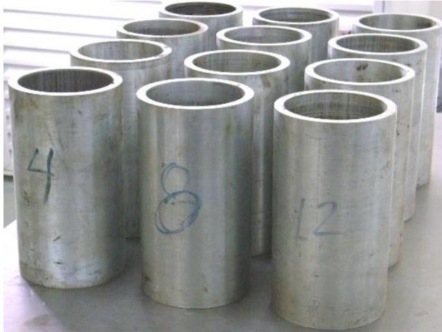
Figura 3.5. Moldes de aço para compactação das misturas asfálticas. (BARRA, 2009)
