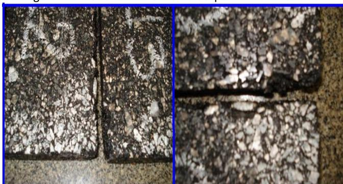
Figura 4.3 Visualização dos efeitos da vaselina no Corpo de Prova testado após o corte.
