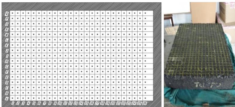
Figura 5.3 Malha feita cada 2 cm no CP para medidas de Ultra-Som com o transdutor de 200 KHz
