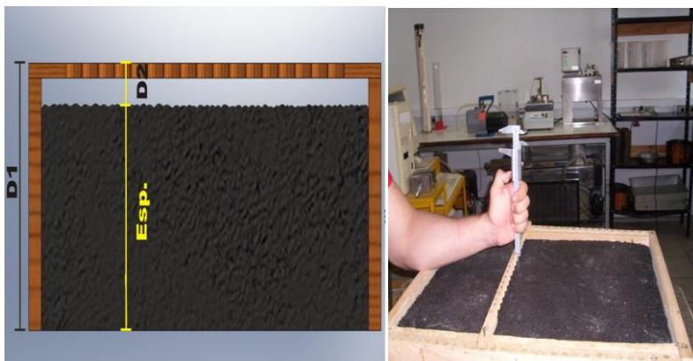
Figura 5.7 Gabarito utilizado para a medição das espessuras das placas de concreto asfálticos.
