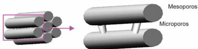
Figura 2 – Esquema ilustrativo do sistema de poros da SBA-15.
