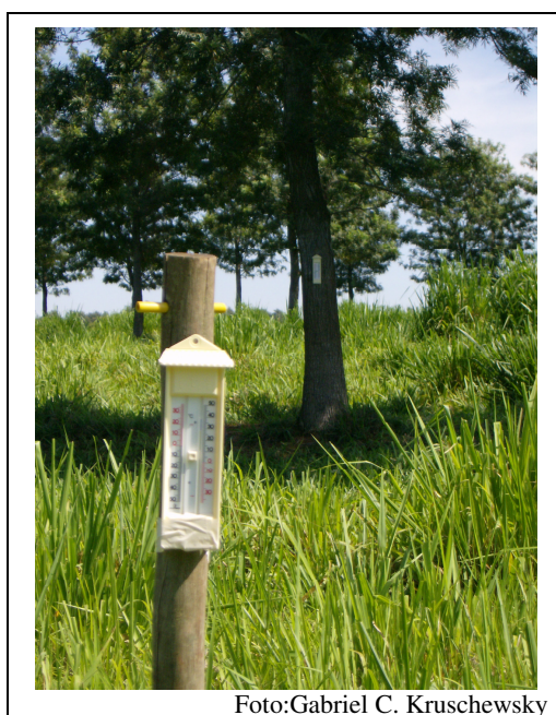
FIGURA 6. Alocação dos termômetros de máxima e mínima no sistema silvipastoril
