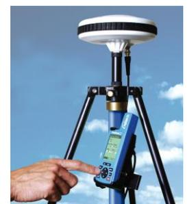
Figura 02: GPS Topográfico
