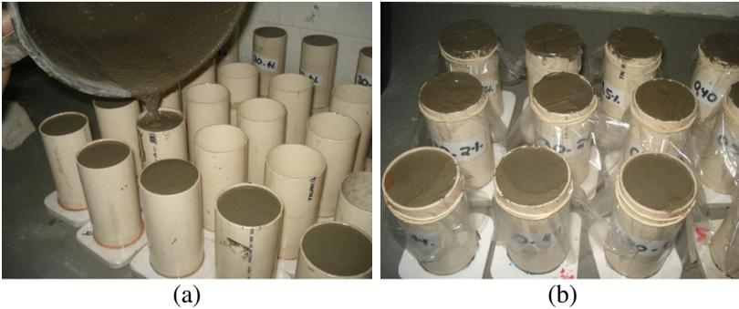
Figura 25 - (a) Moldagem dos corpos de prova sem adensamento. (b) Proteção com plástico no topo dos corpos de prova.
