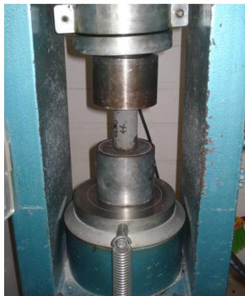
Figura 26 - Ensaio de resistência à compressão axial.
