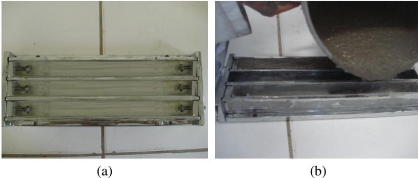
Figura 21 - (a) Molde metálico com forma plástica . (b) moldagem dos prismas.
