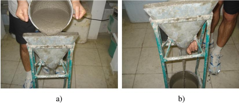
Figura 17 - Ensaio do funil V. Em a) preenchimento do recipiente. Em b) escoamento da argamassa após aberta a portinhola inferior.
