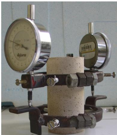
Figura 27 - Ensaio de módulo de deformação: Aparato utilizado para realização do ensaio em corpos de prova cilíndricos, 5 x 10 cm.
