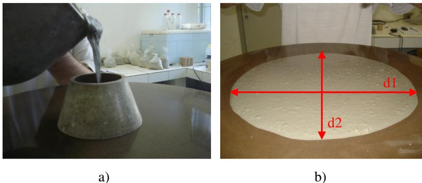
Figura 16 - Ensaio da mesa de abatimento. Em a) preenchimento do recipiente. Em b) espalhamento da argamassa e medidas ortogonais  $d1$  e  $d2$ .
