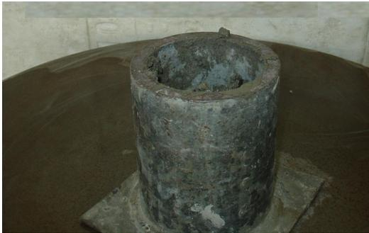
Figura 18 - Recipiente para a realização do ensaio de massa específica.
