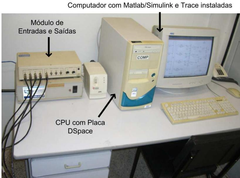
**Figura 4.5 – Sistema de aquisição de dados**
