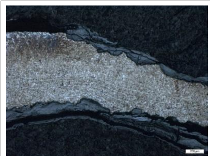
Figura n. 42 – Nital a 2%. As linhas que aparecem acompanhando o formato da amostra são as estrias de conformação do objeto.
