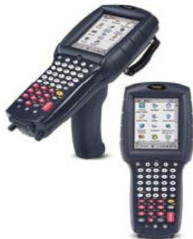
Figura 3.2 - Exemplo de RF para leitura do código de barras
