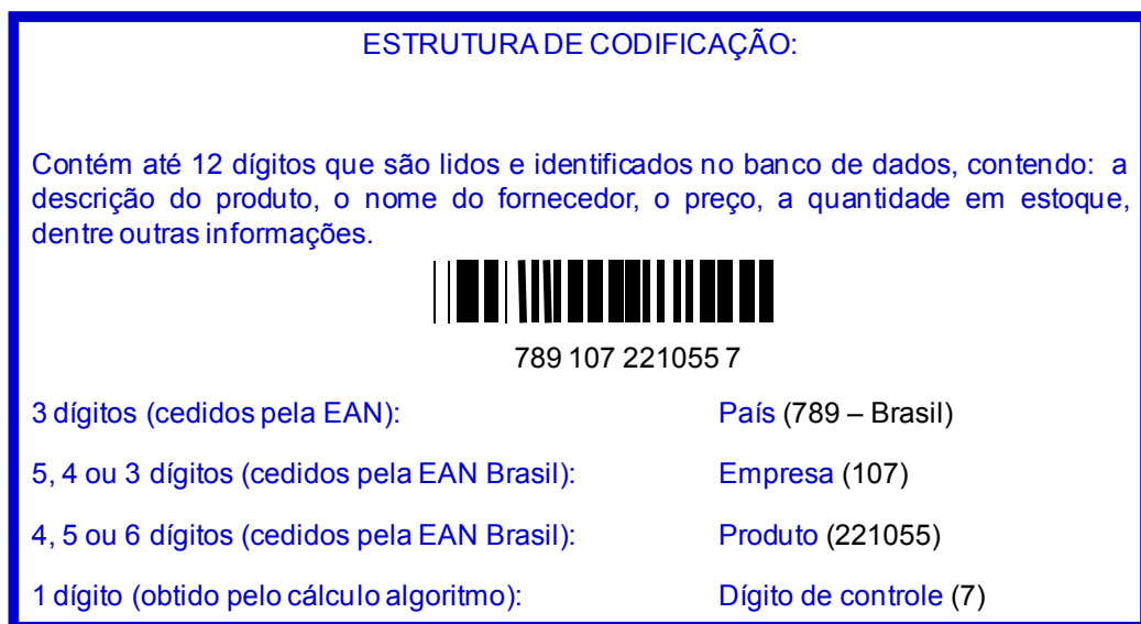
Figura 3.6 - Estrutura de codificação do código de barras
