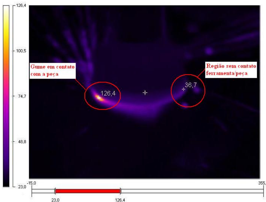
Figura 5-14 – Imagem térmica com um gume em contato com o corpo-de-prova.
