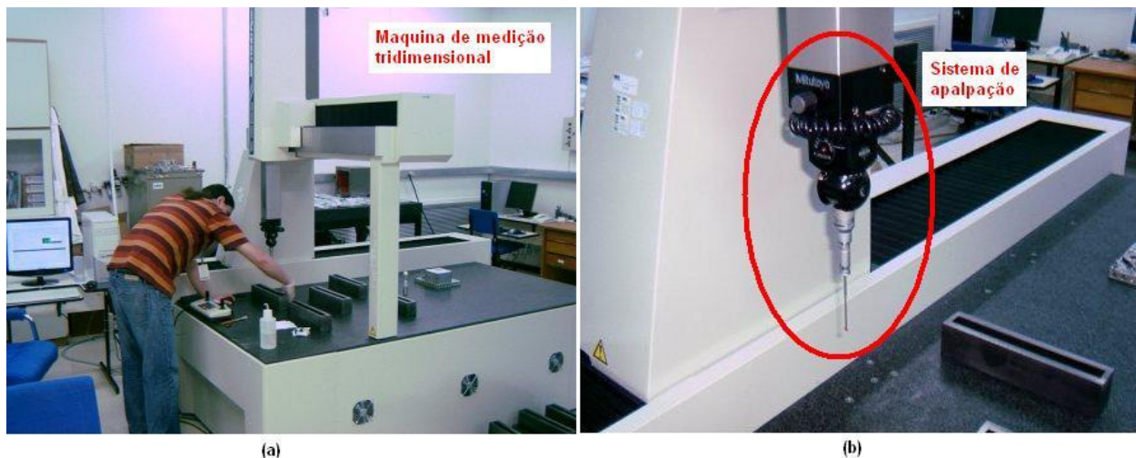
Figura 3-8 – (a) Máquina de medição tridimensional sendo preparada para início da medição, (b) detalhe do sistema de apalpação.
