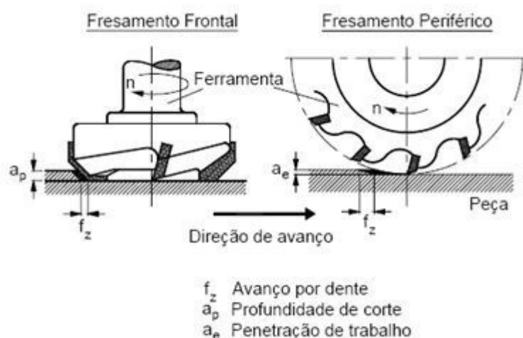
Figura 2-10 – Fresamento frontal e periférico (KÖNIG, 1999 citado por POLLI, 2005).
