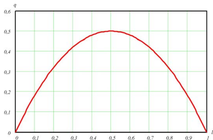
Fig. 2.18 – Característica de transferência do conversor MP-PWM-ZVS Assimétrico.
