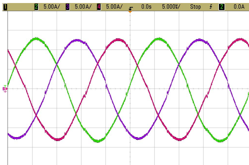
Fig. 7.32 - Correntes ressonantes em condições nominais de projeto do SRC3.
