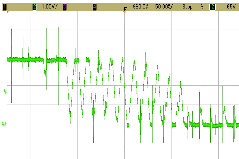
Fig. 7.19 - Detalhe dos pulsos de sincronismo gerados pelo comparador da Fig. 7.18.
