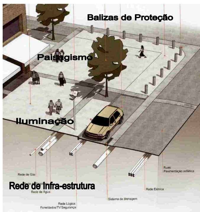
Figura 40: Estrutura da calçada
